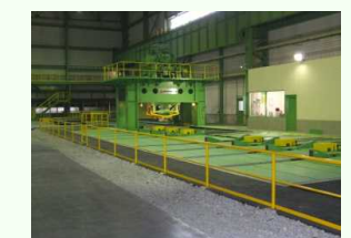
2000tプレス機(新建屋内)
