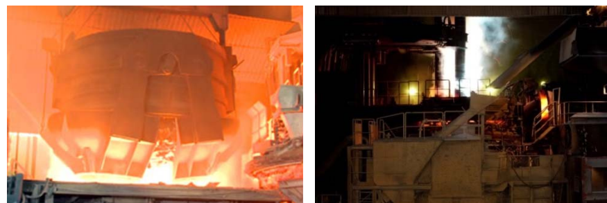
既設電気炉(1962年～稼働中)による作業の様子
