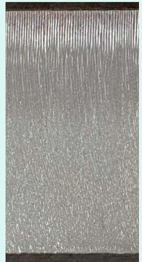
SS400 板厚32mm 切断面
